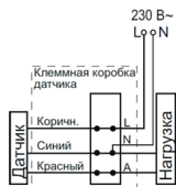
Рисунок 11 - схема подключения датчиков
