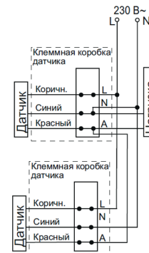
Рисунок 12 - схема параллельного подключения датчиков
